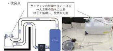
図2. 改良版の模式図 (左) と人工産卵装置 (右)
