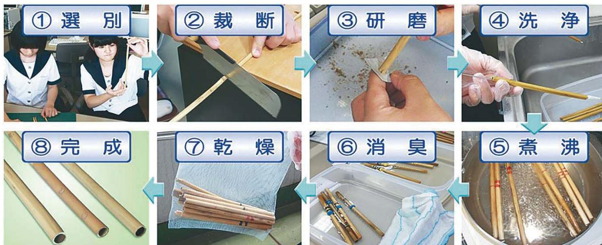
図1. 葦ストローの製造工程
