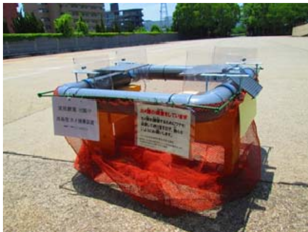
図 3. 浮島型カメ罠（浮島型カメ捕獲装置）
